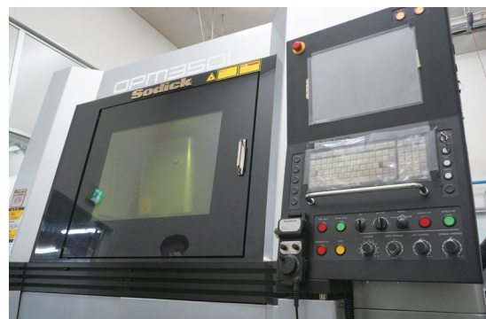
「OPM350L」は、レーザーによる金属粉末の溶融凝固とミリングによる仕上げ加工が可能な高精度加工機
